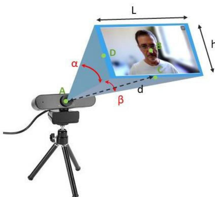
I due angoli di ripresa, quello sul piano verticale  $\alpha$  e quello sul piano orizzontale  $\beta$  sono caratteristici del tipo di webcam utilizzato, e sono collegati da una relazione definita. Il problema generale da risolvere può essere descritto così: quale deve essere il valore  $d$  della distanza a cui deve collocarsi il soggetto da riprendere, al fine di ottenere la giusta inquadratura nelle due dimensioni ( $L$  e soprattutto  $h$ )?
